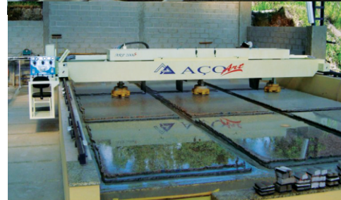
Esteira Série 38 instalada em máquina de polir granito.
