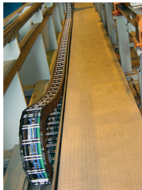
Sistema porta cabos completo, instalada em curso longo.
