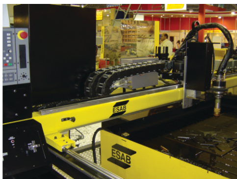
Máquina de Oxicorte - esteiras em paralelo.
