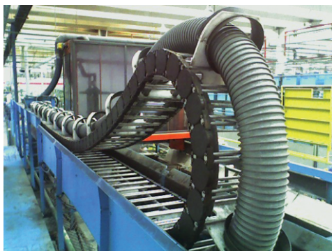
Série 66 adaptada para conduzir um tubo de 6 polegadas de diâmetro.
