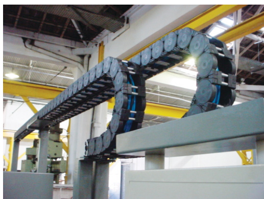
Esteiras instaladas em paralelo em máquina de cartonagem.
