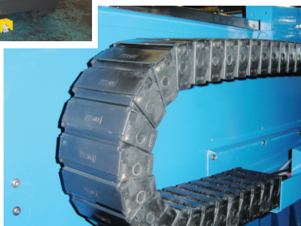
Tubo porta cabos instalado em torno automático.
