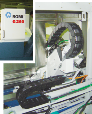
Esteiras Séries 26 e 38 instaladas no eixo "X" e "Z" de um centro de torneamento a comando numérico.
