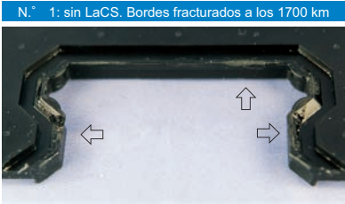
Las áreas marcadas con una flecha están fracturadas.
