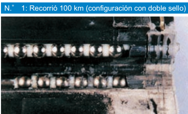
Gran cantidad de material extraño dentro de los canales
